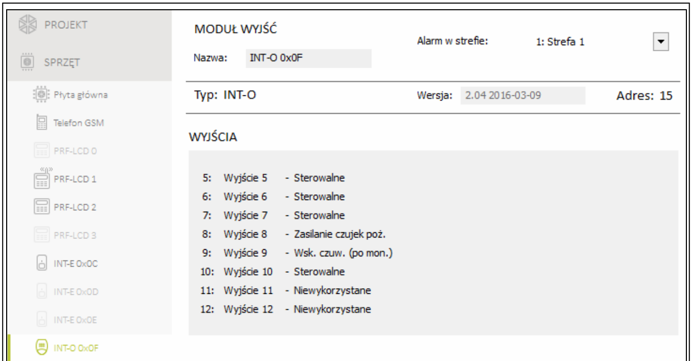
Rys. 12. Zakładka z ustawieniami ekspandera wyjść.
