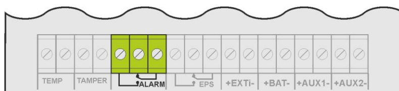
Rys. 9. Wyjście techniczne ALARM.
