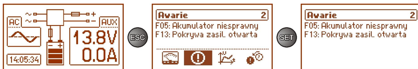
Rys. 10. Ekran – bieżące awarie zasilacza.
