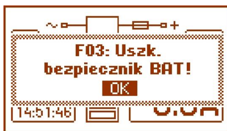
Rys. 9. Komunikat sygnalizujący przepalenie bezpiecznika na wyjściu AUX.
