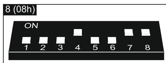
Rys. 10. Sposób ustawienia przełączników DIP-switch w kontrolerze ACU-100.
