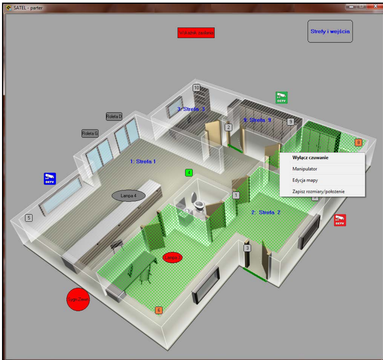
Rys. 35. Przykładowe polecenie sterujące w menu rozwijanym, które wyświetli się po najechaniu kursorem i kliknięciu prawym klawiszem myszki na umieszczonej na mapie, w tym przypadku, strefę.
