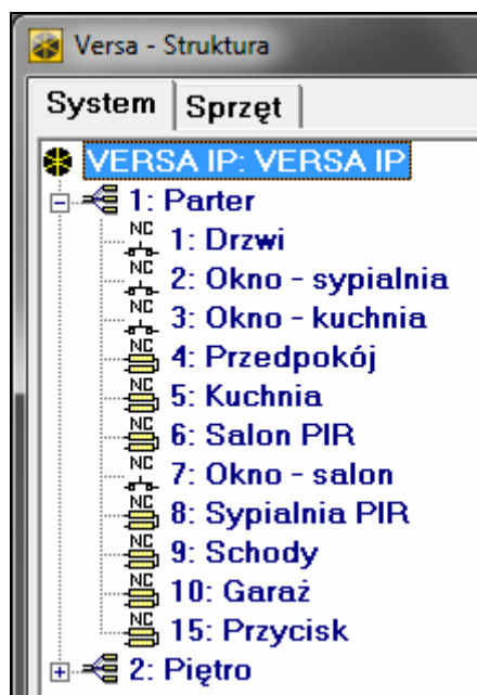
Rys. 6. Program DLOADX: lista stref i wejść w formie drzewa w zakładce „System” w oknie „Versa – Struktura”.
